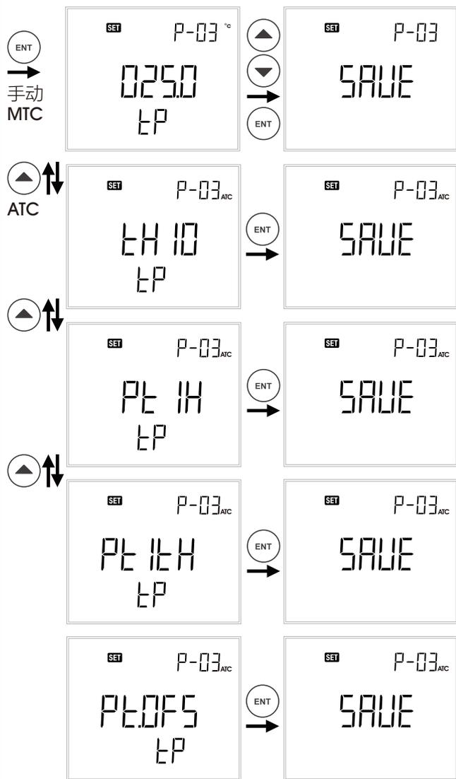
4、如用户选择tOFS(自动温度补偿修正)后按 **ENT** 键，然后再按 **▲** **▼** 键把当前的实际温度值输入，但温差不能超过±10°C，如用户输入温度值超出此范围仪表将自动返回到温度设定画面，重新进行操作。
